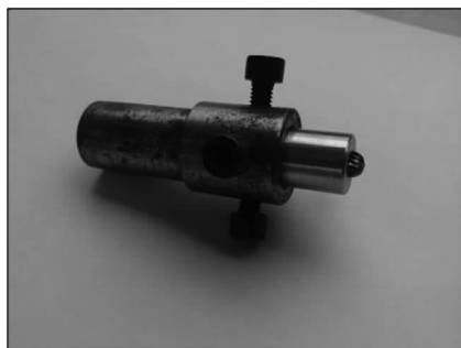
图 1 试验中所用组装式搅拌头 Fig. 1 Compositional welding tool
